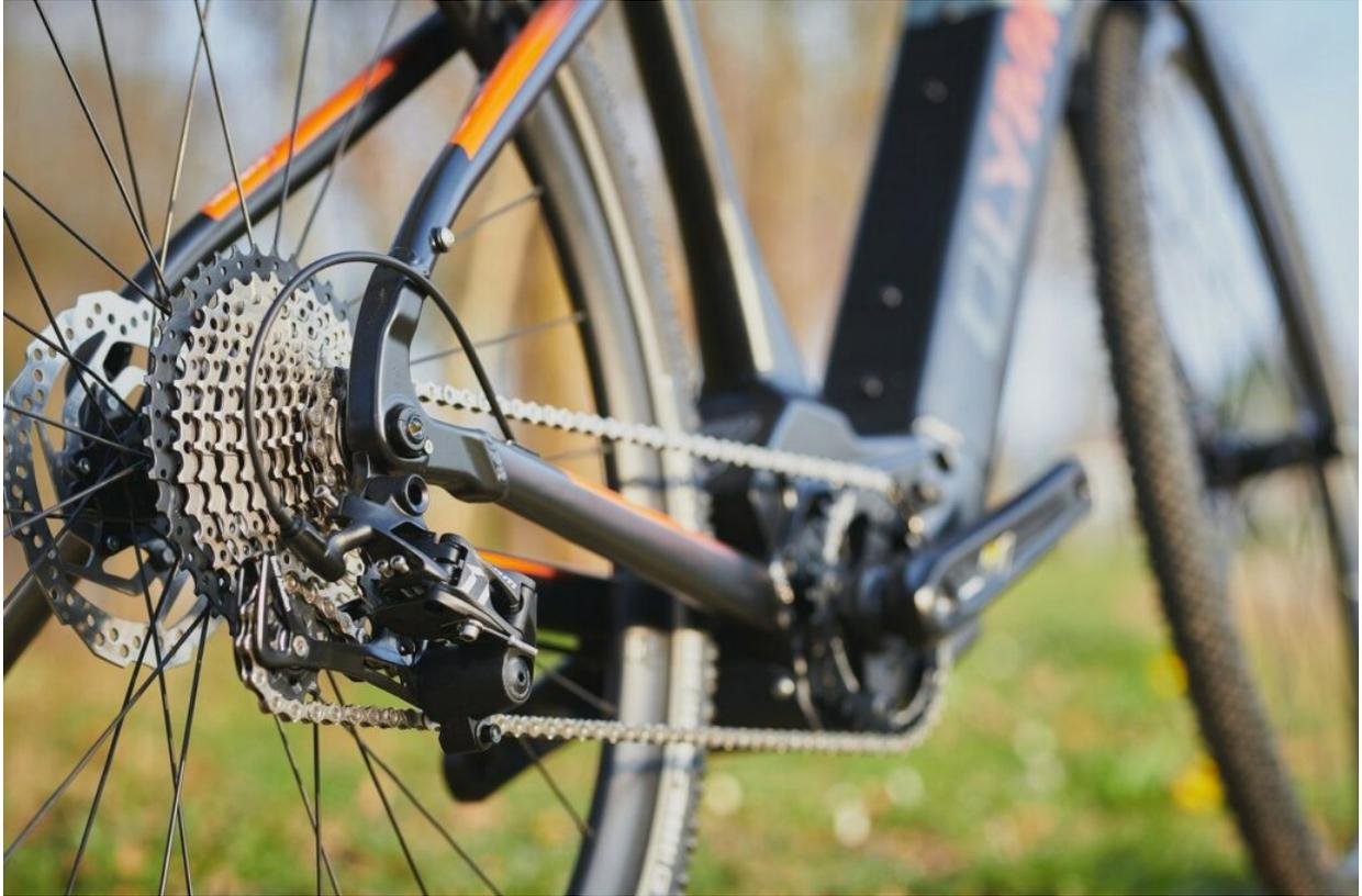
Il **motore italiano Oli da 85 Nm**, che trova ampio utilizzo anche in ambito e-mtb, è stato settato in modo specifico per rendere al meglio sulle tipologie di terreno predilette dagli appassionati del gravel. La **trasmissione Sram Apex da 11 rapporti** consente di trovare sempre la soluzione ideale fra pendenze, caratteristiche del tracciato e stile di pedalata.
