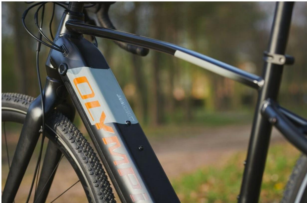
Explorer 900 è equipaggiata con **freni a disco** e viene prodotta **sia con forcella rigida, sia con la variante ammortizzata** dotata di escursione di 60 mm e di lock-out.
