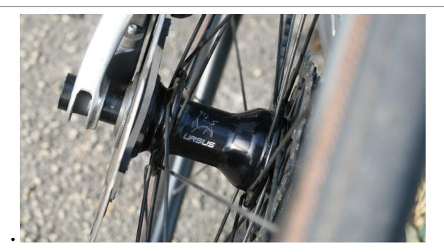
Infine i **mozzi**, anche questi di produzione Ursus: sono i nuovi RD30, con corpo in alluminio Ergal lavorato al CNC e scorrimenti interni identici a quelli impiegati sui set Ursus di fascia superiore, ovvero quelli della famiglia Miura TR e TC. Tra l'altro, per chi volesse un livello di scorrevolezza ancora superiore, è prevista l'**opzione di cuscinetti Ceramic Speed**, diversi dagli **SKF** previsti di serie.
