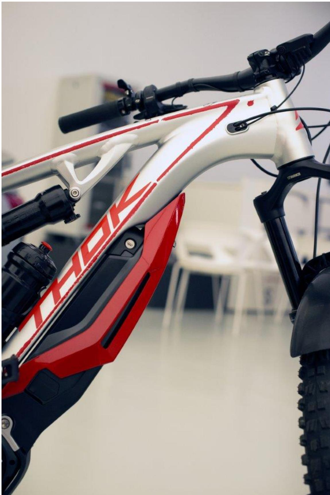
MIG 2.0 di THOK, lanciata a giugno 2020, è una e-mtb adatta sia a chi si avvicina al mondo delle e-mtb, sia ai biker più esperti, in cerca di un mezzo maneggevole, che doni sensazioni simili a quelle che si provano alla guida di una mtb senza motore. Dotata di una batteria da 504Wh – posizionata sotto al tubo obliquo per abbassare il baricentro e aumentare la maneggevolezza – MIG 2.0 monta motore Shimano Steps 7000. La geometria del suo telaio è disegnata sui principi della
