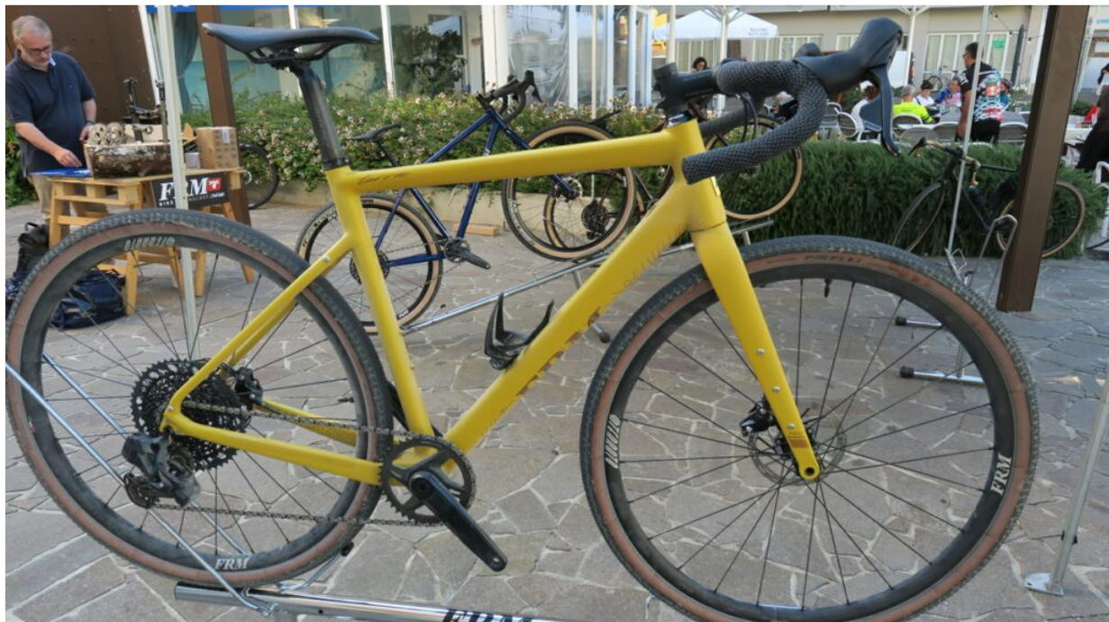
La bici era allestita con una trasmissione elettronica wireless di Sram: sofisticata ma essenziale nel contempo e soprattutto rapidamente fruibile. Si trattava di **comandi e guarnitura di classe Rival** abbinati a un cambio posteriore di serie GX eTap AXS, che agiva su un **pacco pignoni supergeneroso, il 10-52** di estrazione mtb. Accoppiato al **40 anteriore (ovviamente monocorona)** che abbiamo trovato davanti, permette di andare davvero ovunque.
