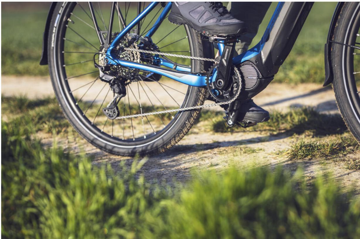
Linkglide è una **piattaforma tecnica nata per soddisfare la problematica** che sulle e-mtb è più frequente legata alla **maggiore usura delle trasmissioni**: proprio l'erogazione di spinta maggiore propria delle "elettriche", impone a tutti gli organi di trasmissione dei carichi sempre più importanti e gravosi.
