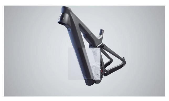
Patron eRIDE è dotata di una tecnologia unica per fornire un supporto ottimale della batteria. Come? La batteria è l'elemento più pesante della bici, quindi è fondamentale averla correttamente montata senza compromettere la facilità di rimozione. La batteria si inserisce nel tubo incorporato nel telaio principale in carbonio. Questa struttura tubo in tubo assicura un facile inserimento della batteria quando è il momento di andare in bicicletta. Anche il passaggio cavi è ordinato.
