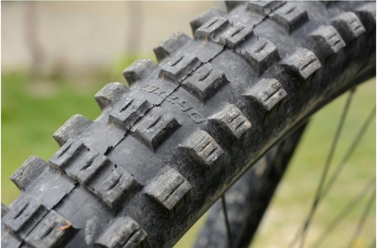
Non si tratta, certo, di pneumatici leggeri, va considerato, però che date le loro caratteristiche si può tranquillamente rinunciare al montaggio sia della camera d'aria sia dell'inserto. Per la stessa ragione riteniamo più conveniente l'utilizzo della versione con sezione inferiore al fine di contenere l'effetto volano che ha un'incidenza negativa, in particolare, sulla ruota anteriore.
