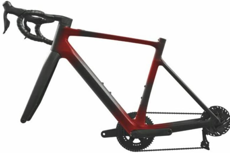
Integrazione sottile e per lo più invisibile dell'unità di azionamento della batteria, del telecomando e della tecnologia Range Booster di SCOTT
