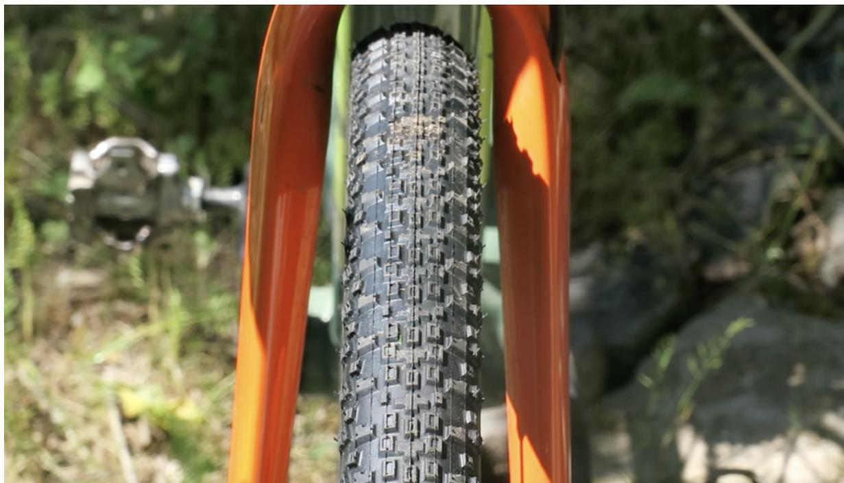
Tutto questo è poi abbinato a un design della carcassa che disegna un **profilo rotondo lungo tutto l'arco di circonferenza** della carcassa, elemento, questo, che permette di guadagnare non solo in scorrevolezza, ma anche e soprattutto in capacità della copertura di “**digerire**” bene le **contropendenze** o i canali che si possono talvolta incontrare sui percorsi gravel, ovvero tutte situazioni che altrimenti potrebbero mettere in crisi aderenza e grip sul terreno.
