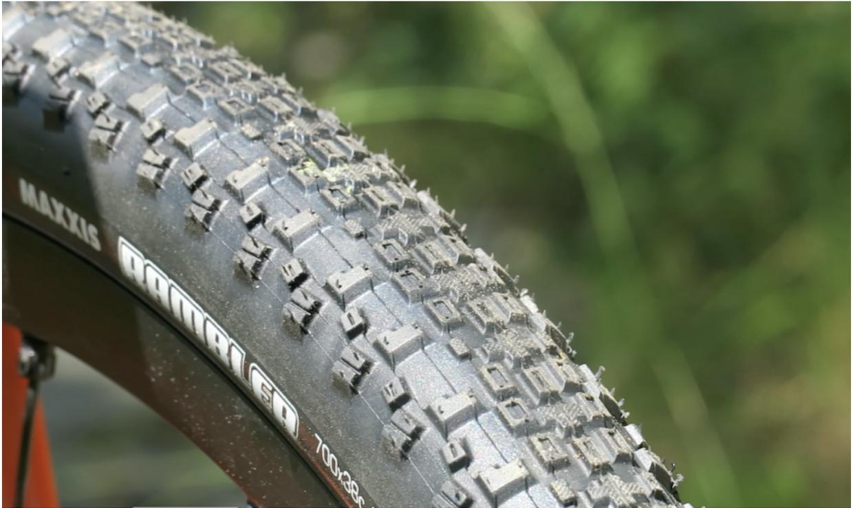
Rambler, inoltre, è provvisto di una **doppia protezione** contro forature e tagli: sui fianchi troviamo la **protezione Exo**, materiale estremamente resistente ai tagli e alle abrasioni; si tratta di un tessuto con trama molto fitta, leggero e altamente flessibile, che non incide sul comportamento della copertura. Inoltre, su tutto l'arco di circonferenza dello pneumatico è impiegata la **protezione SilkShield**, che da tallone a tallone offre un ulteriore presidio in più.
