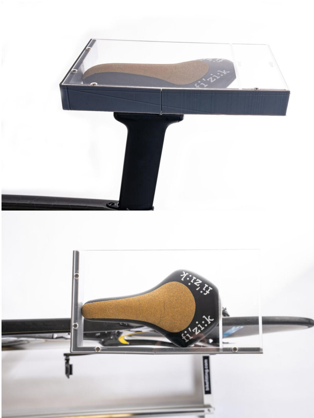
Più nello specifico il nuovo dispositivo utilizza **un software che crea algoritmi sulla base dei dati inseriti**. Il laser box del dispositivo misura rapidamente la bici e le sue geometrie, l'algoritmo determina se la posizione del ciclista è conforme o meno ai regolamenti UCI con il rilascio di un'indicazione a colori. **L'intero processo dura circa trenta secondi**.
