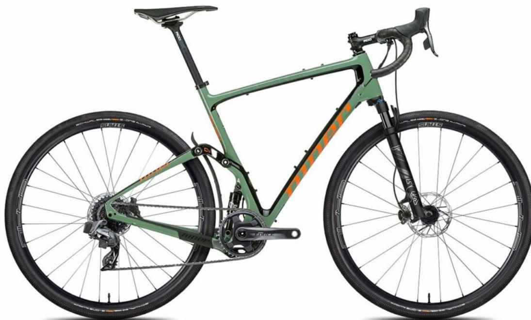
**Questa del marchio del Colorado è una esclusiva gravel full-suspended:** il telaio, interamente in carbonio, ha una vera architettura elastica che sviluppa 50 millimetri di escursione alla ruota gestiti da un ammortizzatore X-Fusion. **Come tutte le 29er di Niner** anche la MCR9 VDO utilizza il sistema elastico CVA (Constantly Varying Arc), con la differenza che in questa fattispecie gravel la sospensione lavora in modo lineare, non progressivo come sulle vere mountain bike, **per**
