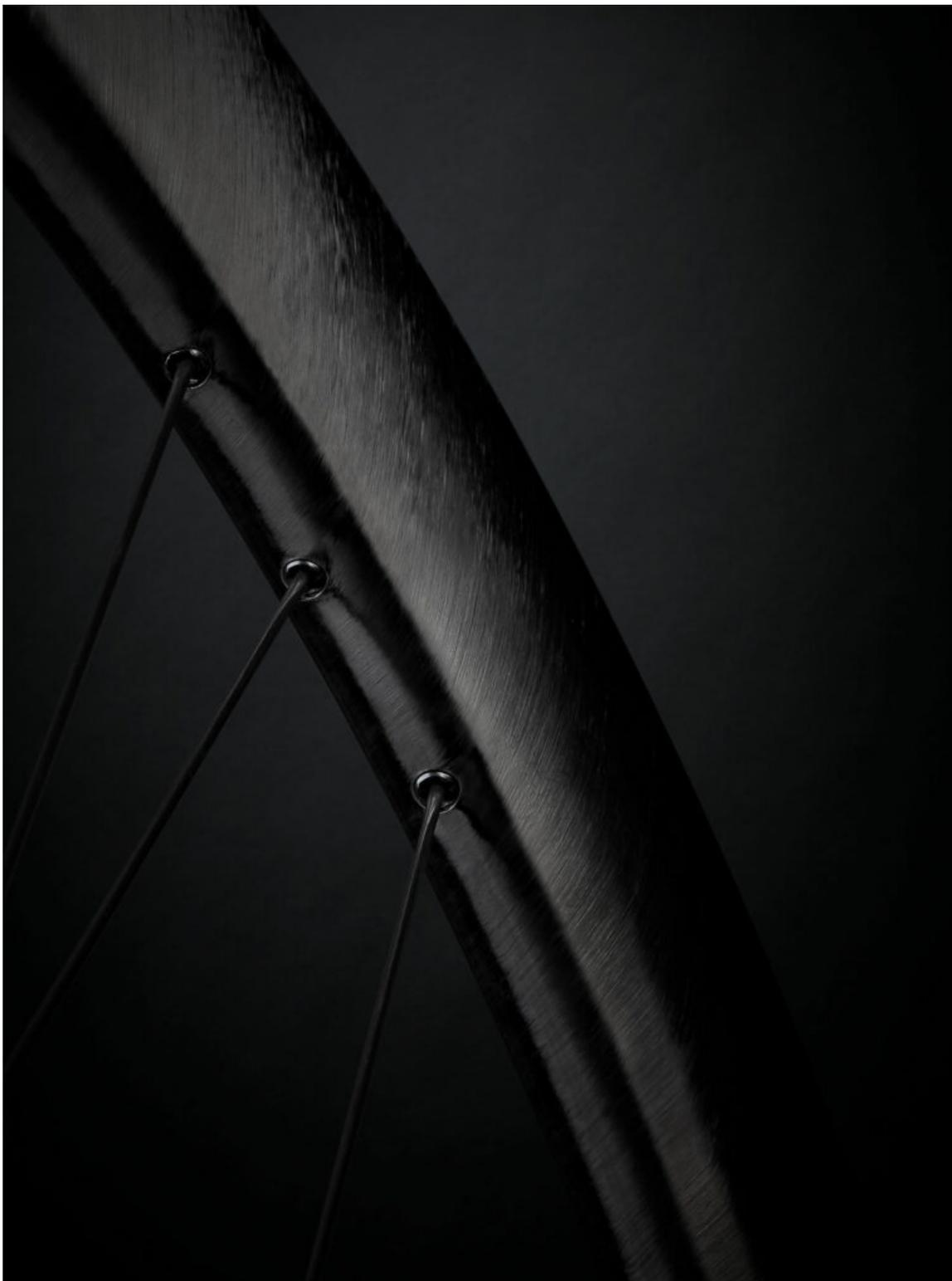
Diversamente che in passato, i nippli sono alloggiati internamente al cerchio: con la tecnologia Aero MO-Mag l'estetica si accoppia alla aerodinamica
