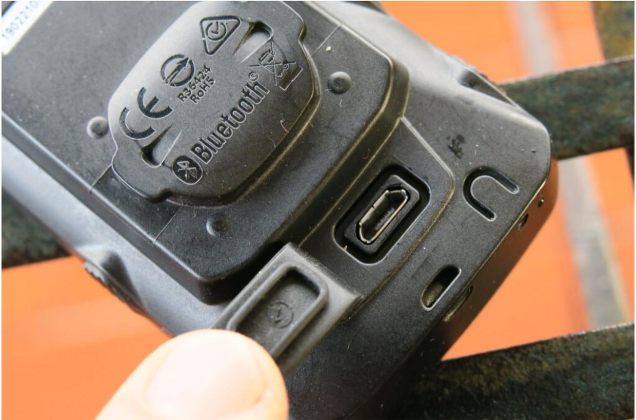
La costruzione dello chassis è in plastica, molto solida, **l'impermeabilità** è quella frequente su dispositivi di questo tipo, la **IPX7**; a protezione dell'acqua è anche la cover in gomma nera che cela la porta di ricarica della batteria integrata.
