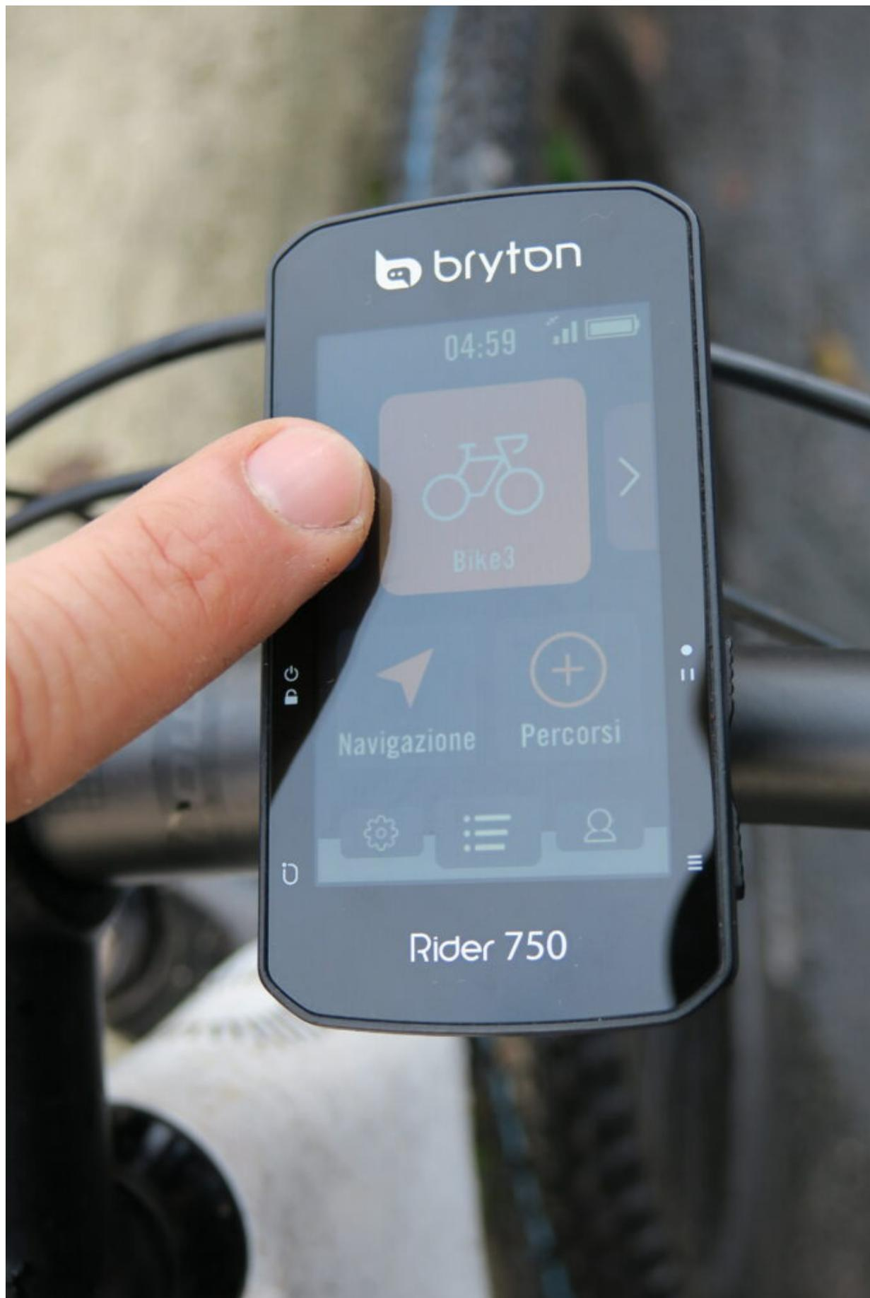
Una volta acceso il device, il primo menu disponibile è quello generale, che – tra le altre cose – permette di scegliere tra **tre profili bici disponibili**, di sincronizzare il dispositivo o accoppiarlo a una rete wifi, impostare i parametri della bici e accoppiarlo ai sensori e ancora di settare le
